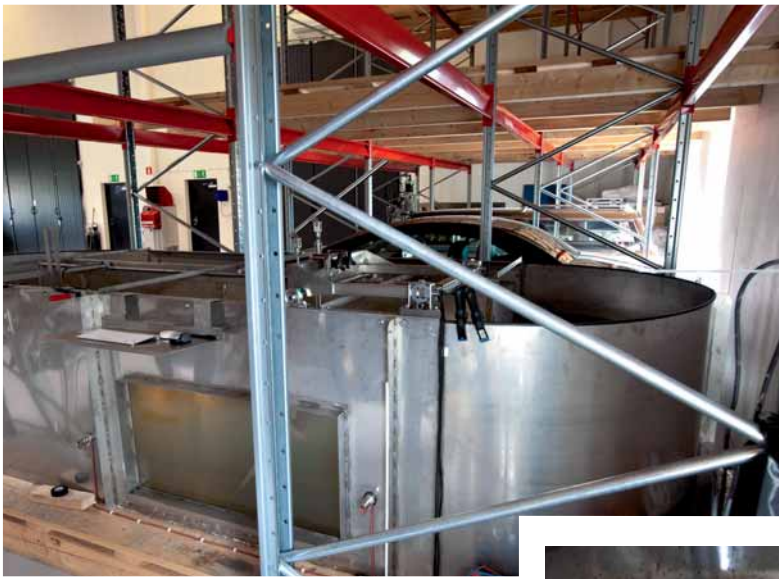
Eftersom det inte finns standardtankar för test av delfinfiner fick man helt enkelt bygga en egen.
