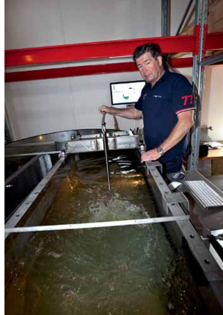
Här sitter fenan för högt i förhållande till vattenytan. Då är det lätt att se hur mycket vatten den flyttar bara genom att Thomas Jemt drar handtaget upp och ned.
