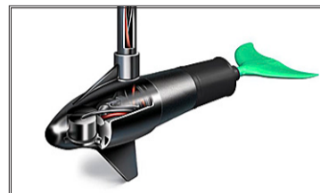
Thomas Jemt med sin uppfinning – en delfinfena som ”båtpropeller”. På bilderna nedan: detaljbild av fenan på motorn samt båtmotorn i sin helhet.
